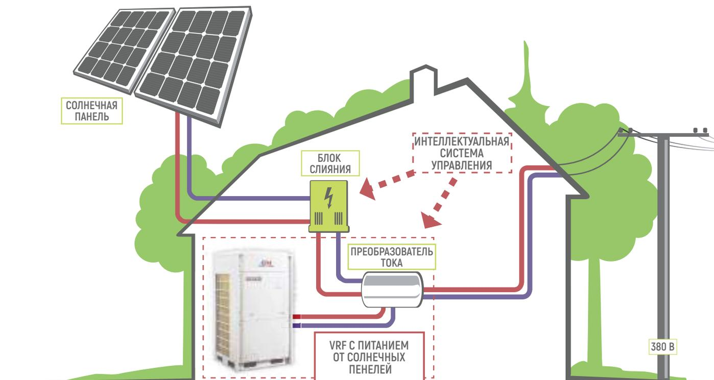
У VRF с питанием от солнечных панелей мощность базовых блоков: 22.4кВт, 28.0кВт, 33.5кВт, мощность комбинированных блоков: от 22.4кВт до 134.0кВт
