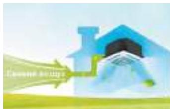
Возможна организация подачи свежего воздуха в помещение через специально подготовленное отверстие в корпусе блока.
