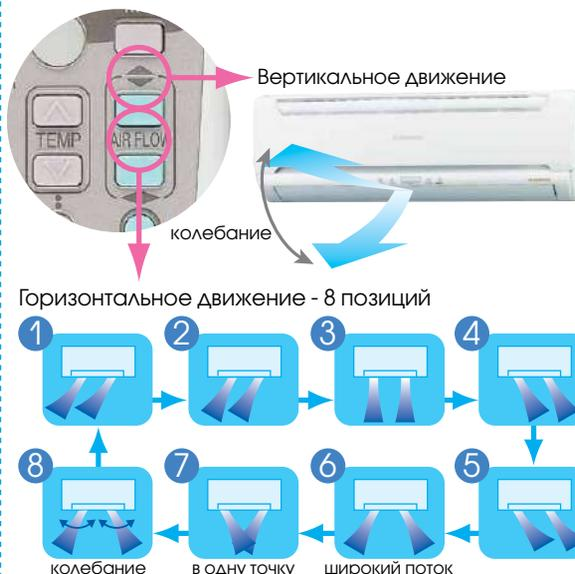
направляется в пол. При концентрации теплого воздуха в нижней части помещения достигается максимальный комфорт.
