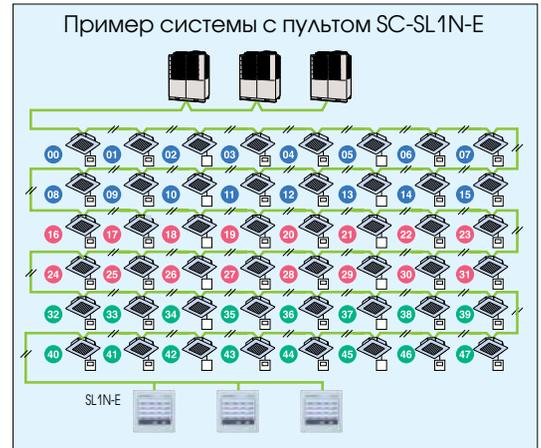
Индикация состояния (неисправен, работает) и одновременный запуск/остановка более одного (до 16) внутренних блоков. Внешние размеры (ВхШхГ): 120 x 120 x 15+62\* мм. \*62 - глубина скрытой в стене части пульта.
