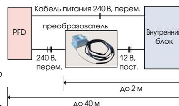
К одному блоку PFD допускается подсоединение группы внутренних блоков общей мощностью до 44,8 кВт (11,2 кВт x 4). При этом все внутренние блоки в группе могут работать одновременно только в одном режиме (обогрев или охлаждение).
