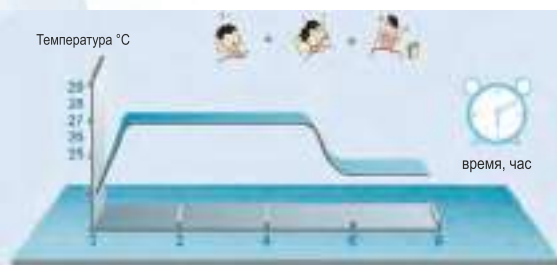
График изменения температуры в режиме охлаждения
